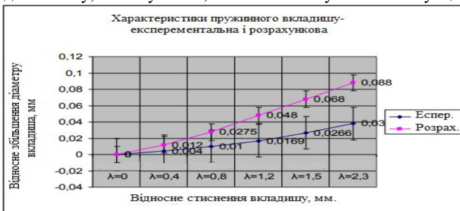
Рисунок 2 Розрахункові та експериментальні характеристики пружинного вкладиша
