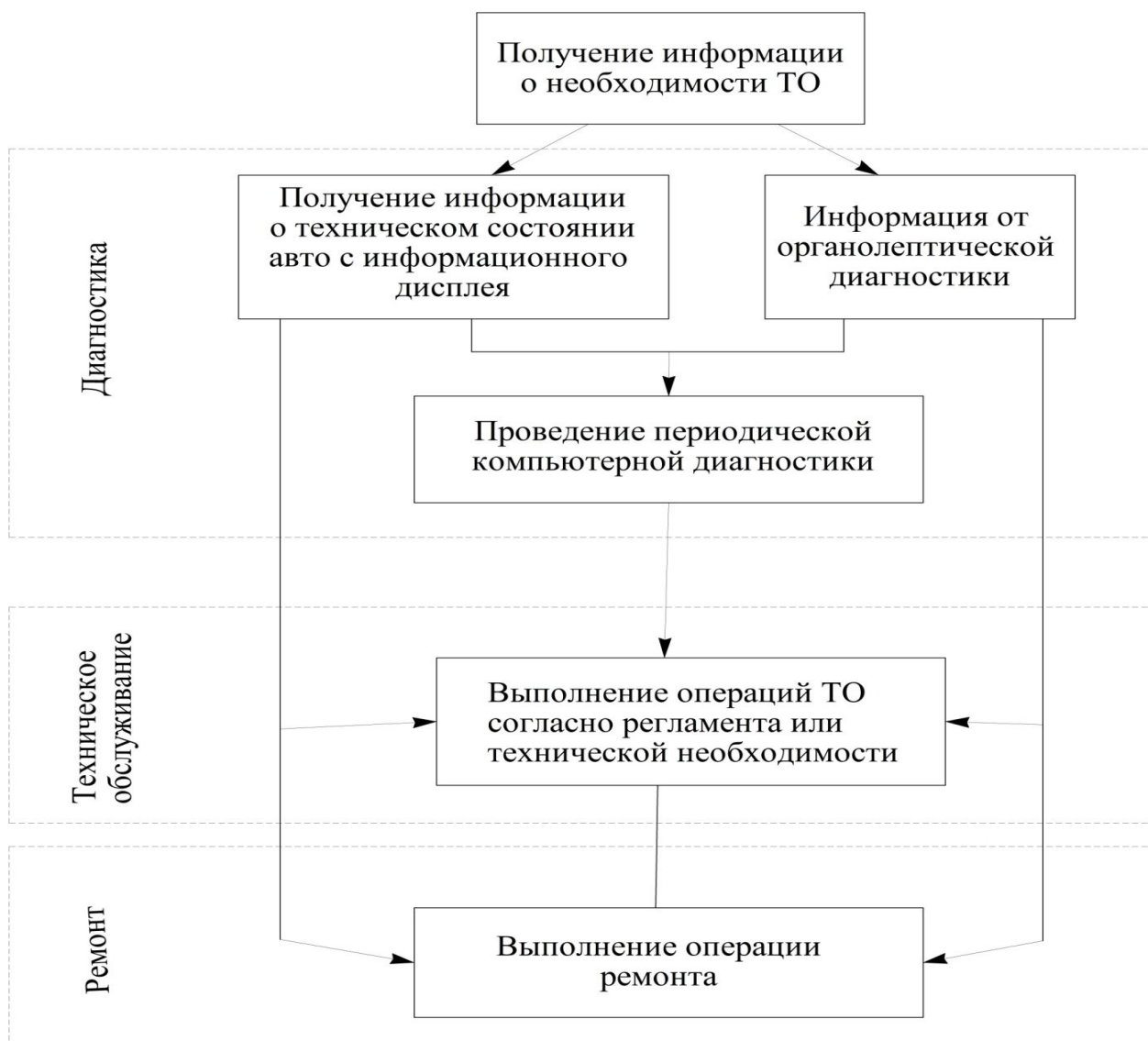
Рисунок 4 Получение диагностической информации о состоянии узлов, систем и агрегатов автомобиля при планово-предупредительной (ППС) и адаптивной системах (АС) ТО и Р
